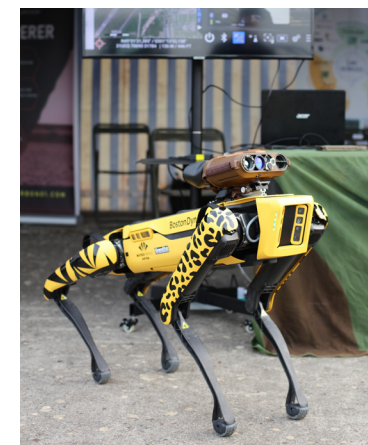
Scar muni de jumelles thermiques Safran, et stream vidéo projeté
